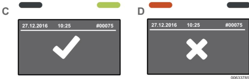
**C)** Pas d'alcool détecté. Le test est réussi. De plus, la diode verte s'allume. Après 2 secondes, l'instrument sera de nouveau prêt à être utilisé.
