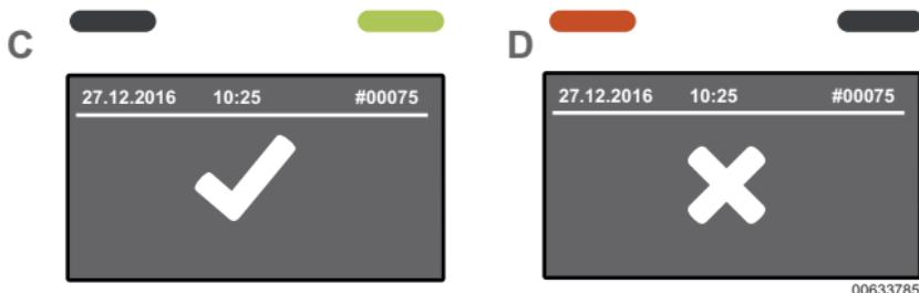
**C)** No s'ha detectat alcohol. S'ha passat la prova. A més, s'il·lumina el LED verd. Després de 2 segons l'aparell estarà llest per ser utilitzat novament.
