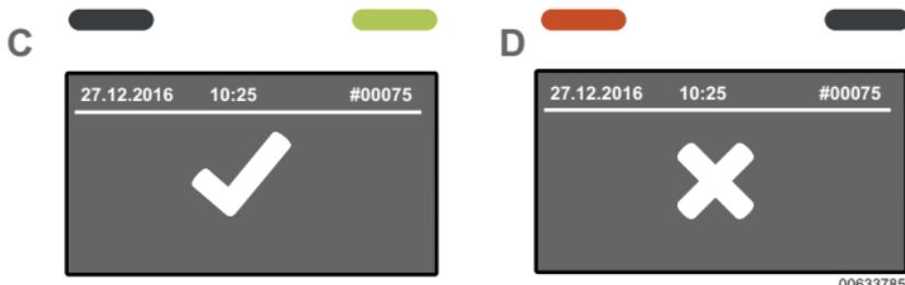
**C)** Alcool non rilevato. Il test è superato. Inoltre, si illumina il LED verde. Dopo 2 secondi, lo strumento sarà nuovamente pronto per l'uso.
