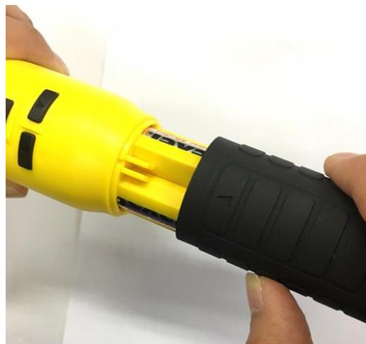
2. Ersetzen Sie die Batterien durch sechs (6) neue 1,5V Alkaline Batterien (LR06,AA) oder durch wiederaufladbare Batterien. Vergewissern Sie sich bitte, dass die Batterien richtig eingelegt werden (beachten Sie dazu das Batterieschema auf dem rückseitigen Etikett).
