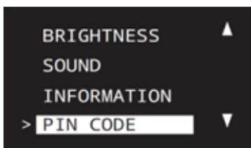
Dans ce menu, le code PIN correct doit être saisi pour accéder à l'option de menu avancée. Le code PIN par défaut est 0000, et le code PIN peut être réglé de 0000 à 9999 dans l'option de menu avancée.
