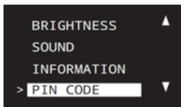
In diesem Menü muss der richtige PIN-Code eingegeben werden, um in die erweiterte Menüoption zu gelangen. Der Standard-PIN-Code ist 0000, und der PIN-Code kann in der erweiterten Menüoption von 0000 bis 9999 eingestellt werden.
