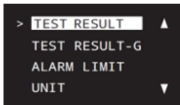
Die Testergebnisse können unter dem Reiter „TEST RESULT“ überprüft werden. Dabei wird die Testnummer, das Testergebnis sowie Datum und Uhrzeit mitgespeichert. Das letzte Messergebnis wird dabei als Erstes angezeigt.
