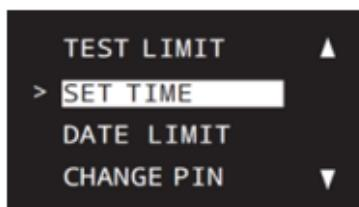
Um die Ziffern der Uhrzeit und des Datums zu ändern, drücken Sie die Einschalttaste für 2 Sekunden.
