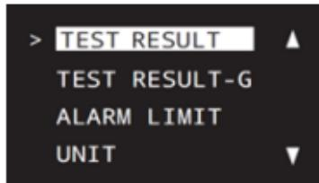
De testresultaten kunnen worden gecontroleerd onder het tabblad „TEST RESULT“. Het testnummer, het testresultaat en de datum en tijd worden opgeslagen. Het laatste meetresultaat wordt eerst weergegeven.
