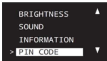
In dit menu moet de juiste pincode worden ingevoerd om toegang te krijgen tot de geavanceerde menuoptie. De standaardpincode is 0000 en de pincode kan worden ingesteld van 0000 tot 9999 in de geavanceerde menuoptie
